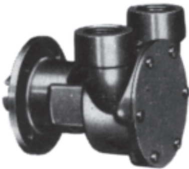
REFERENCIA 551074 Cuerpo de bronce. Caudal: 38 l/minuto, conexiones: 3/4". Modelo 3270-200. Motor Perkins.
