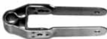
REF. 901297 Abrazadera de timón superior para pala fija de Vaurient. Medidas: 113x20x2 mm, interior: 24mm. Para espigones 901292 y 901293.
