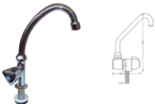
REFERENCIA 021501 Grifo sencillo giratorio, fabricado en latón cromado. Altura máxima: 250 mm, diámetro base: 40 mm, anchura máxima: 150 mm, conexión: 1/2".
