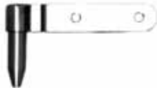
REF. 901182 Espigón de timón superior. Medidas de abrazadera: 83x15 mm, diámetro de la espiga: 10 mm.
