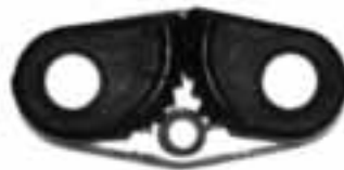
REF. 901122 Fabricada en acero inoxidable y levas delrín con dos dientes de acero en cada leva. Medidas base 60x29 mm, para cabos hasta 10 mm.
