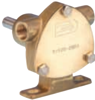
REFERENCIA 551053 Cuerpo de bronce. Caudal: 18 l/minuto, conexiones: 1/2". Eje libre. Modelo 51520-2001.
