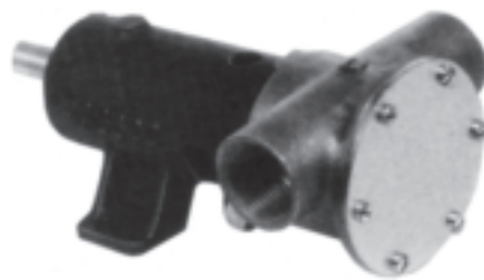
REFERENCIA 551060 Cuerpo de bronce. Caudal: 107 l/minuto, conexiones: 1". Modelo 9710-200. Eje libre.
