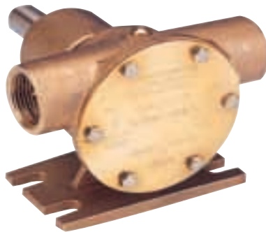
REFERENCIA 551057 Cuerpo de bronce. Caudal: 40 l/minuto, conexiones: 3/4". Modelo 52040-2001. Eje libre.
