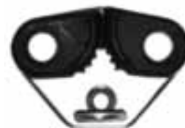
REF. 901123 Fabricada en acero inoxidable, levas delrín y dos dientes de acero en cada leva, con anilla para guiar el cabo. Medidas de base 60x42 mm, para cabos hasta 10 mm.
