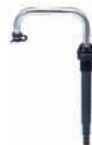
REFERENCIA 021500 Grifo telescópico fabricado en aluminio anodizado color plata y plástico. Para tubo de 10 y 13 mm. Altura máxima: 125 mm, diámetro de anclaje: 20 mm.
