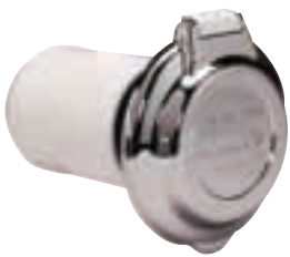
REFERENCIA 511003 Base toma de cubierta de acero inoxidable. 18/8/2. 125v-50 Amp./220v-32 Amp.
