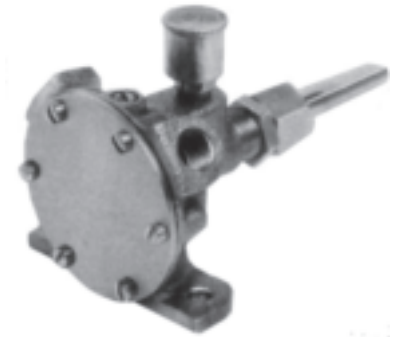
REFERENCIA 551076 Cuerpo de bronce. Caudal: 40 l/minuto, conexiones: 1/2". Modelo 4900-200. Eje libre.
