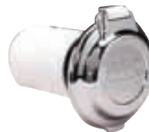
REFERENCIA 511010 Base toma de cubierta . Especial para barcos americanos. Dispone de 2 polos en «L» y uno recto.125 v-50 Amp./ 220 v-32Amp.
