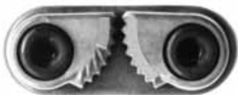
REF. 901129 Fabricada en aluminio anodizado. Medidas de base 70x27 mm, para cabos hasta 14 mm. Fijación por dos tornillos de 5 mm. Distancia entre centros : 43 mm.
