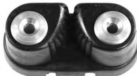
REF. 903291 Fabricada en acero inoxidable con base y levas de delrín. Posee casquillos de Delrín internos que actúan como cojinetes. Medidas de base 65x27 mm, para cabos hasta 12 mm. Fijación por dos tornillos de 5 mm. Distancia entre taladros: 38 mm.
