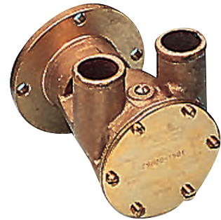
REF. 551075 Cuerpo de bronce. Caudal: 37 l/minuto, conexiones: 3/4". Modelo 9970-200. Eje libre. Para motores MWN-Diter y Perkins.
