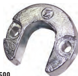
REF. 051599 Herradura con 2 agujeros para elevador de cola Alpha-One. Peso: 0,1 kg. Diámetro: 44 mm.
