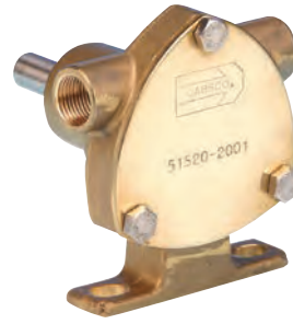
REF. 551053 Cuerpo de bronce. Caudal: 18 l/minuto, conexiones: 1/2". Eje libre. Modelo 51520-2001.
