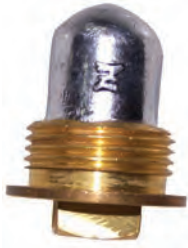
REF. 051687 Ánodo con tuerca de latón. Peso: 0,1 kg. Diámetro: 40 mm. Rosca: 1" gas x 182".
