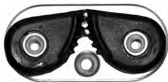
REFERENCIA 901121 Fabricada en acero inoxidable y levas delrín. Medidas de base 82x39 mm, para cabos hasta 12 mm, con ejes taladrados para fijación robusta.
