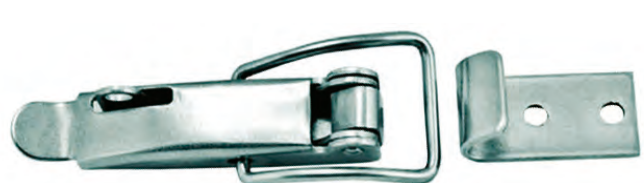
REF. 401016 Fabricado en latón cromado. Diámetro del orificio para el candado: 6,5 mm, medidas: 100x30 mm.
