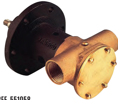
REF. 551058 Cuerpo de bronce. Caudal: 53 l/minuto, conexiones: 3/4". Modelo 10550-200. Eje libre.
