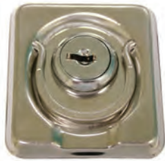
REF. 401053 Cierre con llave y tirador fabricado en acero inox AISI-316. Múltiples aplicaciones como tambuchos, cajones, trampillas, etc. Medidas: 49x52 mm.
