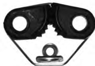
REFERENCIA 901123 Fabricada en acero inoxidable, levas delrín y dos dientes de acero en cada leva, con anilla para guiar el cabo. Medidas de base 60x42 mm, para cabos hasta 10 mm.
