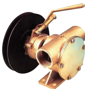
REF. 551064 Cuerpo de bronce. Embrague mecánico. Conexiones: 1", caudal: 107 l/minuto. Modelo 51080-2003.
