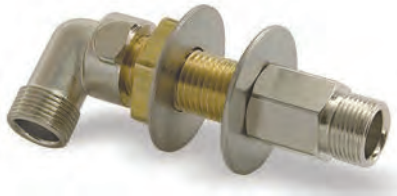
REF. 665512 Pasacascos para tubos Seastar de 3/8" a través del casco. Máximo espesor: 20 mm. Kit de dos unidades. Para sistema de un cilindro.
