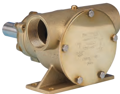
REF. 551062 Cuerpo de bronce. Caudal: 200 l/minuto, conexiones: 1 1/2". Modelo 52200-2011. Eje libre.
