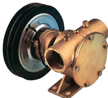
Cuerpo de bronce. Embrague Electromagnético. Conexiones: 1", caudal: 107 l/minuto.
