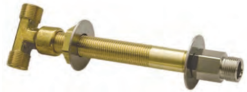
REF. 665515 Pasacascos para tubos Seastar de 3/8" a través del casco. Máximo espesor: 76 mm. Kit de dos unidades. Para sistema de dos cilindros.
