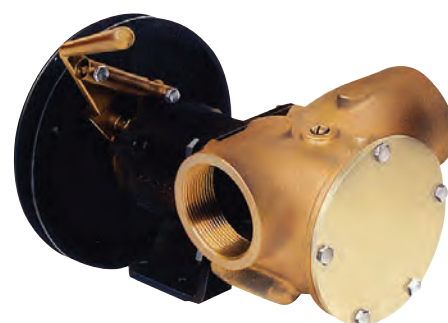
REF. 551082 Cuerpo de bronce. Embrague mecánico. Conexiones: 2", caudal: 370 l/minuto. Modelo 51270-2013.
