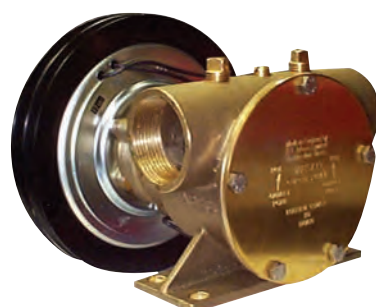
Cuerpo de bronce. Embrague electromagnético. Conexiones: 1 1/2", caudal: 260 l/minuto.
