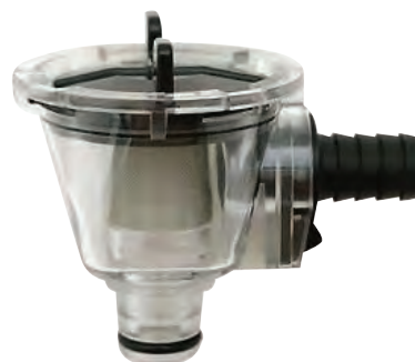
REF. 551017 Filtro para bomba de presión Seaworld totalmente transparente para rápida inspección. Rejilla de acero inox. Conectores tipo «Quick Connect» para tubos de 13 y 15 mm. Medidas : 65 x 65 x 73 mm.
