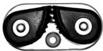
REFERENCIA 901120 Fabricada en acero inoxidable y levas delrín, medidas de base 82x39 mm, para cabos hasta 12 mm.
