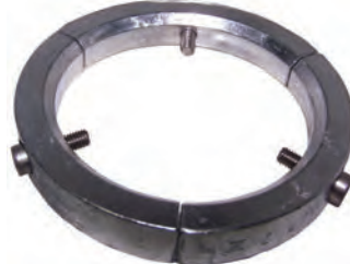
REF. 051691 Ánodo trío para hélices plegables para colas S. Vienen con 3 tornillos M5x16. Peso: 0,26 kg. Diámetro: 84 mm.
