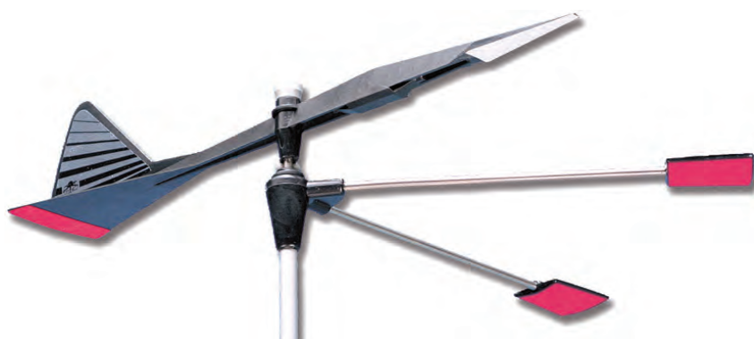
REFERENCIA 601017 Veleta para competición Modelo Mistral. Fabricada en poliamida de color negro y aluminio anodizado. Dispone de accesorios para montaje sobre el mástil o para montaje lateral. Reflectante, para navegación diurna o nocturna.
