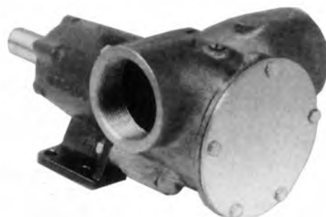
REF. 551063 Cuerpo de bronce. Caudal: 270 l/minuto, conexiones: 2". Modelo 52270-2011. Eje libre.
