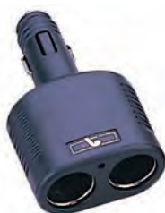
REF. 501248 Base toma de corriente doble. Fabricada en poliamida. Color negro. 12v. 10 A. Diámetro interior: 20 mm.
