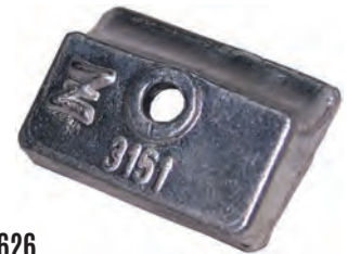
REF. 051626 Ánodo para Johnson 9,9-15 Hp. Peso: 0,065 kg. Medidas: 38x27 mm.
