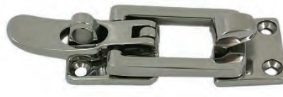
REF. 401016 Fabricado en latón cromado. Diámetro del orificio para el candado: 6,5 mm, medidas: 100x30 mm.
