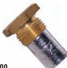
REF. 051600 Ánodo enfriador de motor Rosca M18x150 hilos. Peso: 0,064 kg. Long: 28 mm.
