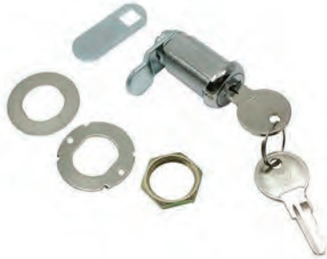
REF. 404933 Cierre con llave. Fabricado en latón pulido y cromado. Muy útil para cajones y armarios. Longitud de la rosca: 30 mm.
