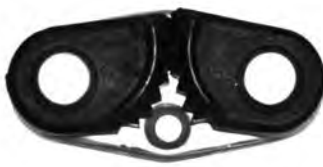
REFERENCIA 901122 Fabricada en acero inoxidable y levas delrín con dos dientes de acero en cada leva. Medidas base 60x29 mm, para cabos hasta 10 mm.
