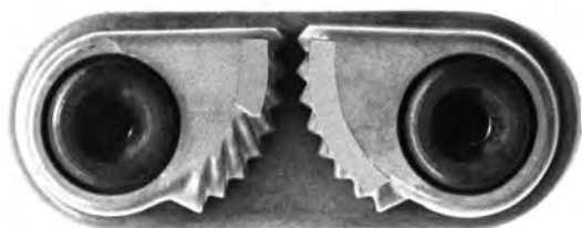
REF. 901129 Fabricada en aluminio anodizado. Medidas de base 70x27 mm, para cabos hasta 14 mm. Fijación por dos tornillos de 5 mm. Distancia entre centros: 43 mm.
