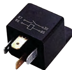
REF. 501452 Relé con soporte. 24 V. 40 A. Abre y cierra el circuito.
