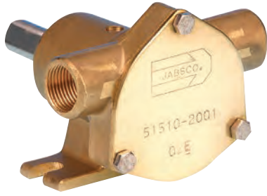
REF. 551051 Cuerpo de bronce. Caudal: 10 l/minuto, conexiones: 3/8". Eje libre. Modelo 51510-2001.
