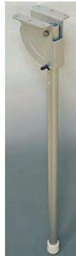
REF. 601312 Pie soporte de asiento plegable con resorte y cierre para evitar su pliegue. Fabricado en duraluminio anodizado. Longitud total 670 mm. El tubo puede ser cortado a la medida deseada hasta un mínimo de 200 mm.
