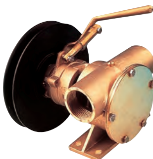
REF. 551081 Cuerpo de bronce. Embrague mecánico. Conexiones: 1 1/2", caudal: 260 l/minuto. Modelo 51200-2003.
