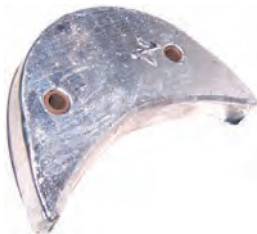
REF. 051624 Placa para motor fueraborda V-4 140 Hp. Peso: 0,87 kg. Medidas: 118x78 mm.
