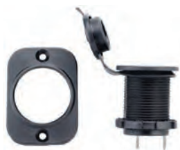
REF. 501420 Base toma de corriente. Fabricada en poliamida y cubierta de PVC. Color negro. 12v. 20 A. Diámetro interior: 20 mm.
