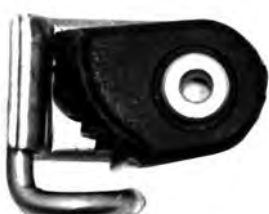
REFERENCIA 901125 Fabricada en acero inoxidable, levas delrín. Medidas de base 38x21 mm, para cabos hasta 6 mm.
