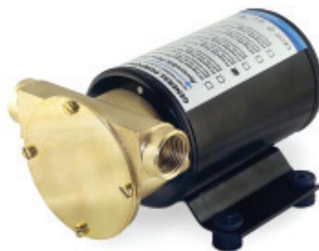
Autoaspirante, cuerpo de latón, impulsor de nitrilo y eje de acero inoxidable. Ideal para trasvase de líquidos y productos químicos. Bocas de entrada y salida 19 mm. Cebado automático, hasta 5 m de elevación vertical. Dirección de flujo reversible. Caudal 45 litros/minuto. Medidas: 180x90x120 mm. Peso 1 Kg.
