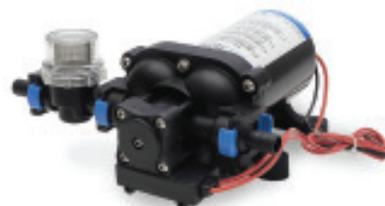
Bombas de presión de agua autoaspirantes, cinco cámaras y cuatro membranas, presostato incorporado, para 4 o 5 puntos de agua. Conexiones: Entronques de entrada y salida tipo «Quick Connect» para tubo de 1/2" (13 mm). Filtro incluido. **Cumplen normas 'CE.'**
