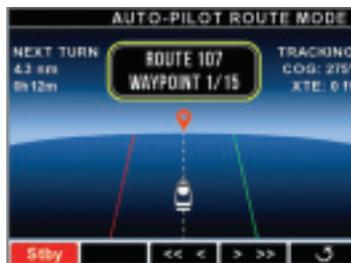
El piloto automático se desactiva temporalmente cuando se gira el timón. El piloto automático vuelve a activarse automáticamente cuando ya no se gira el timón y el rumbo de la embarcación es estable. Cuando el piloto automático se vuelve a activar, el rumbo actual se convierte en el nuevo rumbo deseado.
